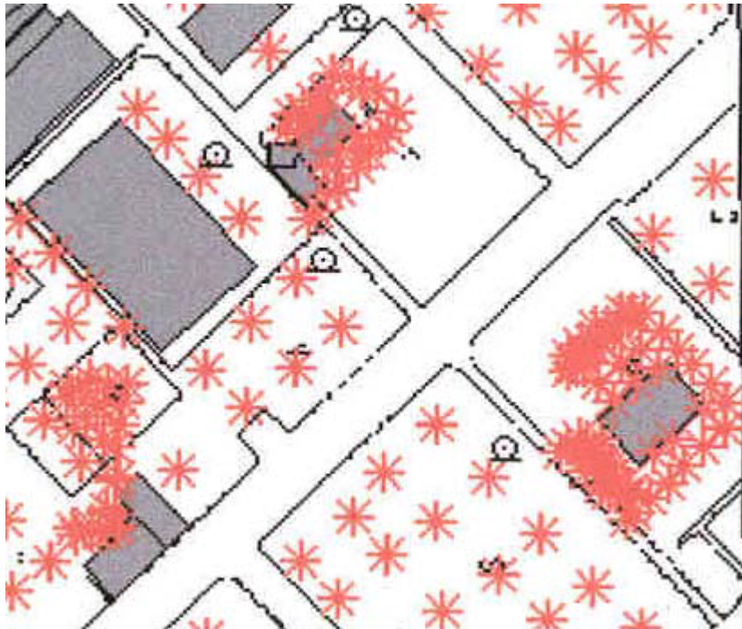
figuur 2. Detail van een akoestische verkaveling (dB(A)/m 2 ) laat zien waar het meeste geluid wordt geproduceerd
